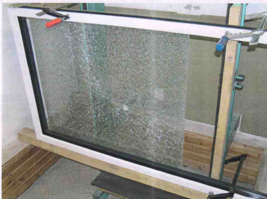
Stav zasklení typu č.1 po úderech s energií 150 J a 250 J
