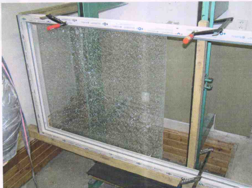
Stav zasklení typu č.2 po úderech s energií 150 J a 250 J
